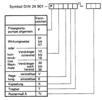
Bezeichnung eines Symbols für Flüssigkeitspumpe (P) als konstruktives Merkmal "Kreiskolbenpumpe" (12) ohne Regelung (O) mit Kapselung (K) nicht tragbar (O) von Rastermaß 3) h = 5 mm:
